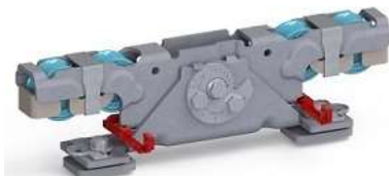
Doppelaufrollentechnologie samt Entgleisungsschutz und Exzenterschraube zur Höhenangleichung
