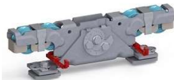
Doppelaufrollentechnologie samt Entgleisungsschutz und Exzenterschraube zur Höhenangleichung
