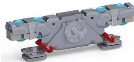
Doppelaufrollentechnologie samt Entgleisungsschutz und Exzenterschraube zur Höhenangleichung
