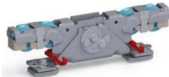
Doppellaufrollentechnologie samt Entgleisungsschutz und Exzenterschraube zur Höhenangleichung
