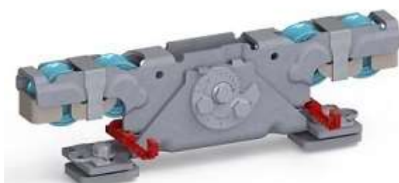
Doppelaufrollentechnologie samt Entgleisungsschutz und Exzenterschraube zur Höhenangleichung
