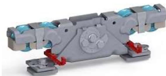
Doppelaufrollentechnologie samt Entgleisungsschutz und Exzenterschraube zur Höhenangleichung
