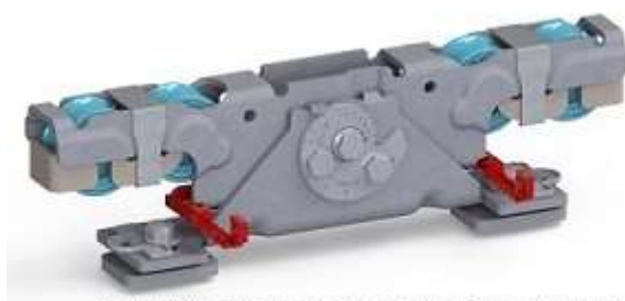
Doppelaufrollentechnologie samt Entgleisungsschutz und Exzenterschraube zur Höhenangleichung
