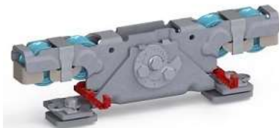
Doppelaufrollentechnologie samt Entgleisungsschutz und Exzenterschraube zur Höhenangleichung
