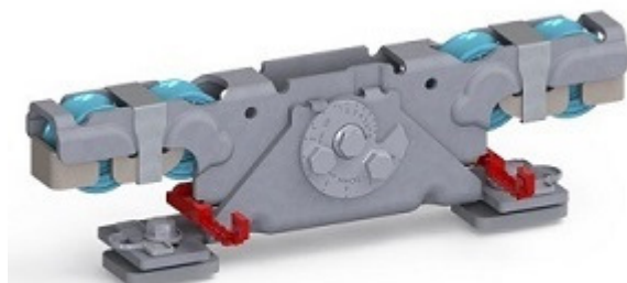
Doppelaufrollentechnologie samt Entgleisungsschutz und Exzentrerschraube zur Höhenangleichung
