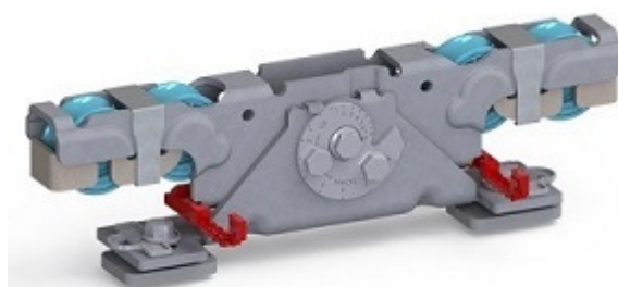
Doppelaufrollentechnologie samt Entgleisungsschutz und Exzentrerschraube zur Höhenangleichung
