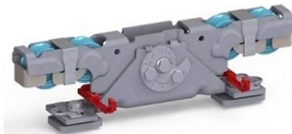
Doppelaufrollentechnologie samt Entgleisungsschutz und Exzenterschraube zur Höhenangleichung
