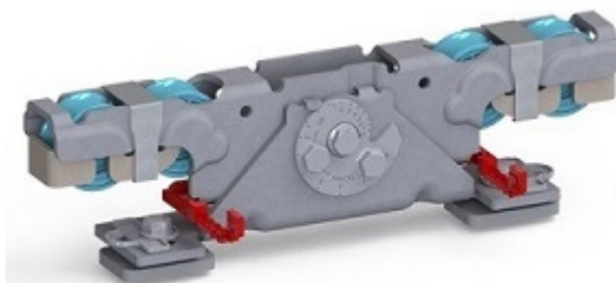
Doppelaufrollentechnologie samt Entgleisungsschutz und Exzenterschraube zur Höhenangleichung
