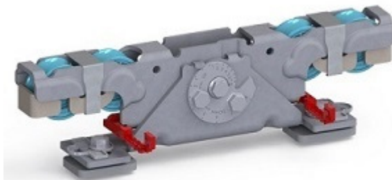
Doppelaufrollentechnologie samt Entgleisungsschutz und Exzenterschraube zur Höhenangleichung
