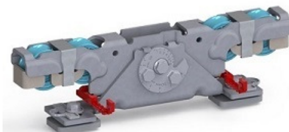
Doppelaufrollentechnologie samt Entgleisungsschutz und Exzentrerschraube zur Höhenangleichung
