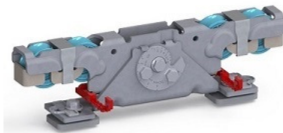
Doppelaufrollentechnologie samt Entgleisungsschutz und Exzenterschraube zur Höhenangleichung
