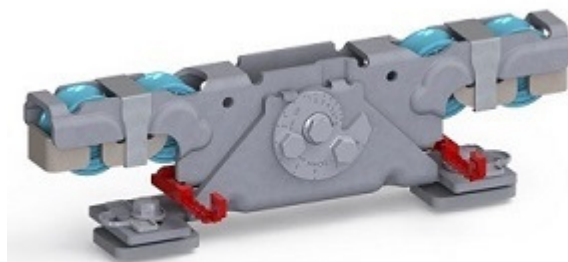
Doppelaufrollentechnologie samt Entgleisungsschutz und Exzenterschraube zur Höhenangleichung
