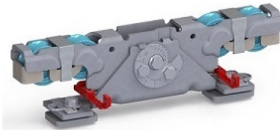
Doppelaufrollentechnologie samt Entgleisungsschutz und Exzenterschraube zur Höhenangleichung
