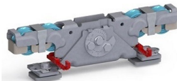
Doppelaufrollentechnologie samt Entgleisungsschutz und Exzenterschraube zur Höhenangleichung
