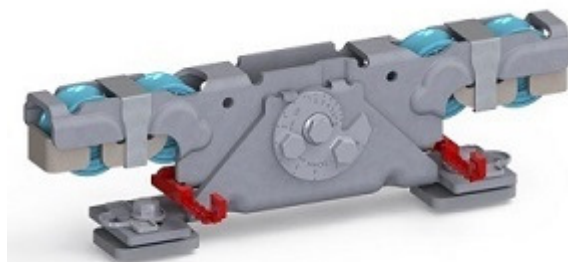
Doppelaufrollentechnologie samt Entgleisungsschutz und Exzenterschraube zur Höhenangleichung
