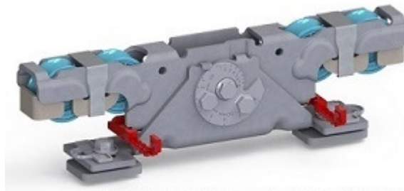
Doppelaufrollentechnologie samt Entgleisungsschutz und Exzenterschraube zur Höhenangleichung
