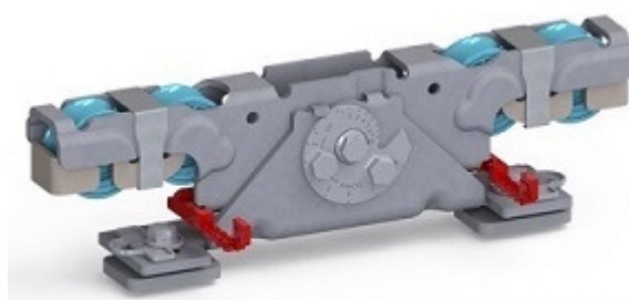
Doppelaufrollentechnologie samt Entgleisungsschutz und Exzenterschraube zur Höhenangleichung
