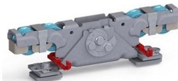
Doppelaufrollentechnologie samt Entgleisungsschutz und Exzenterschraube zur Höhenangleichung
