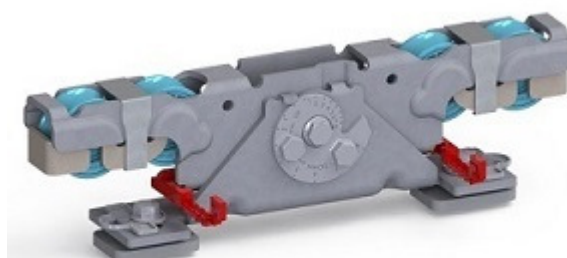
Doppelaufrollentechnologie samt Entgleisungsschutz und Exzenterschraube zur Höhenangleichung
