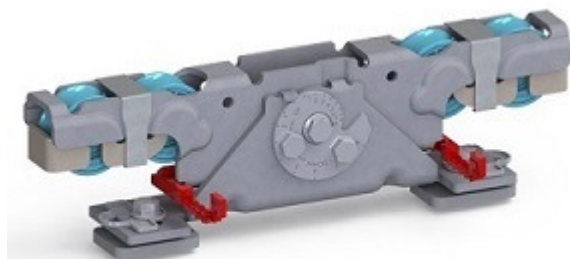
Doppelaufrollentechnologie samt Entgleisungsschutz und Exzenterschraube zur Höhenangleichung
