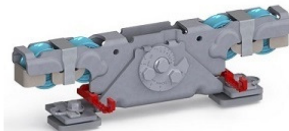
Doppelaufrollentechnologie samt Entgleisungsschutz und Exzenterschraube zur Höhenangleichung
