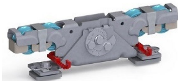
Doppelaufrollentechnologie samt Entgleisungsschutz und Exzentrerschraube zur Höhenangleichung
