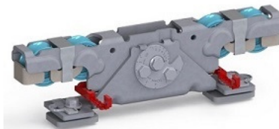
Doppelaufrollentechnologie samt Entgleisungsschutz und Exzentrerschraube zur Höhenangleichung
