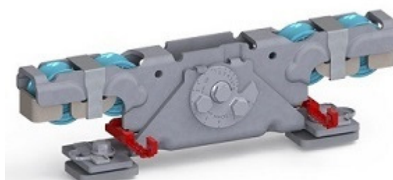
Doppelaufrollentechnologie samt Entgleisungsschutz und Exzentrerschraube zur Höhenangleichung
