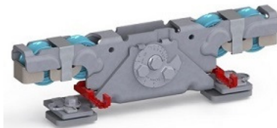
Doppelaufrollentechnologie samt Entgleisungsschutz und Exzentrerschraube zur Höhenangleichung
