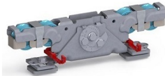
Doppelaufrollentechnologie samt Entgleisungsschutz und Exzenterschraube zur Höhenangleichung
