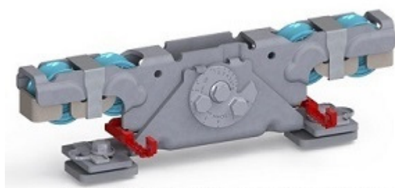
Doppelaufrollentechnologie samt Entgleisungsschutz und Exzentrerschraube zur Höhenangleichung
