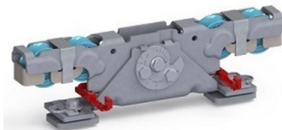
Doppelaufrollentechnologie samt Entgleisungsschutz und Exzenterschraube zur Höhenangleichung
