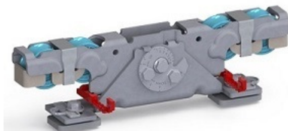
Doppelaufrollentechnologie samt Entgleisungsschutz und Exzentrerschraube zur Höhenangleichung
