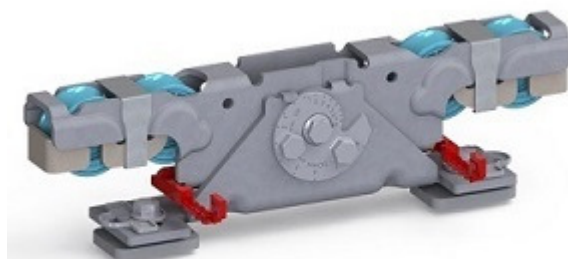
Doppelaufrollentechnologie samt Entgleisungsschutz und Exzenterschraube zur Höhenangleichung
