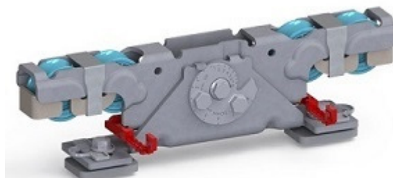
Doppelaufrollentechnologie samt Entgleisungsschutz und Exzenterschraube zur Höhenangleichung
