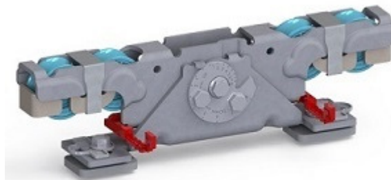
Doppelaufrollentechnologie samt Entgleisungsschutz und Exzentrerschraube zur Höhenangleichung
