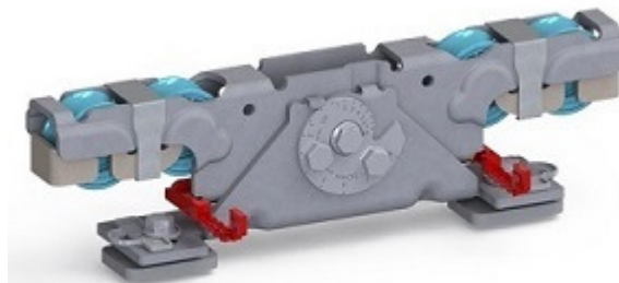
Doppelaufrollentechnologie samt Entgleisungsschutz und Exzenterschraube zur Höhenangleichung
