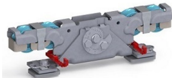
Doppelaufrollentechnologie samt Entgleisungsschutz und Exzenterschraube zur Höhenangleichung
