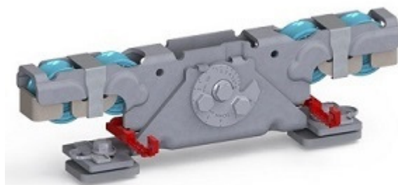
Doppelaufrollentechnologie samt Entgleisungsschutz und Exzentrerschraube zur Höhenangleichung
