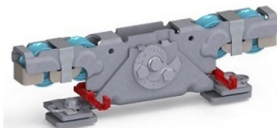
Doppelaufrollentechnologie samt Entgleisungsschutz und Exzenterschraube zur Höhenangleichung
