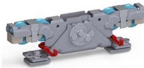
Doppelaufrollentechnologie samt Entgleisungsschutz und Exzenterschraube zur Höhenangleichung
