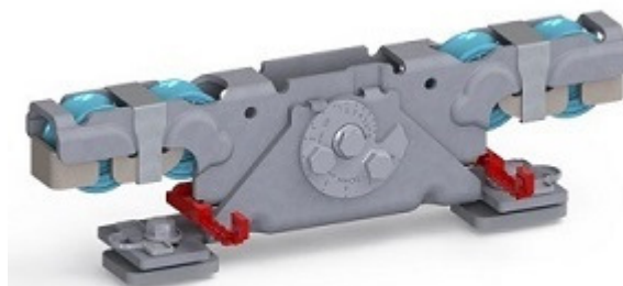
Doppelaufrollentechnologie samt Entgleisungsschutz und Exzenterschraube zur Höhenangleichung
