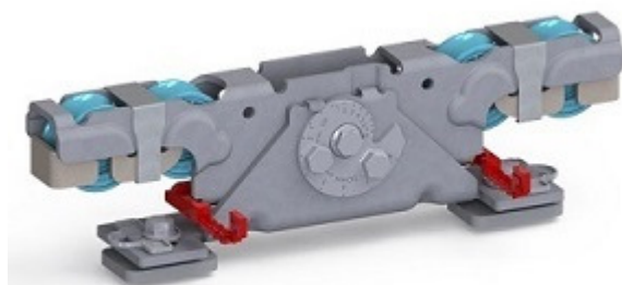
Doppelaufrollentechnologie samt Entgleisungsschutz und Exzentrerschraube zur Höhenangleichung
